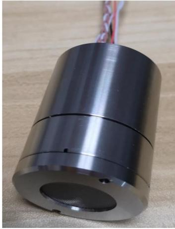
本产品是为激光瓦斯传感器提供的核心检测模块，采用可调谐激光光谱吸收（TDLAS）技术对目标气体进行精确测量，内部包含了激光及驱动单元、激光发射接收单元、调制解调单元、光电转换及采集单元以及数据处理及通讯单元。
